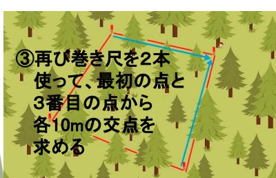
③再び巻き尺を2本使って、最初の点と3番目の点から各10mの交点を求める
