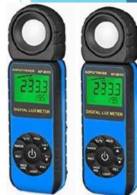
デジタル照度計 必ず2台使用し、森林内と裸地を同時に測ります。
